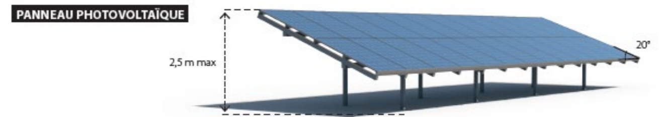
Figure 4: Plan de coupe de la structure fixe (Source : Composite – Paysage et Territoire)
